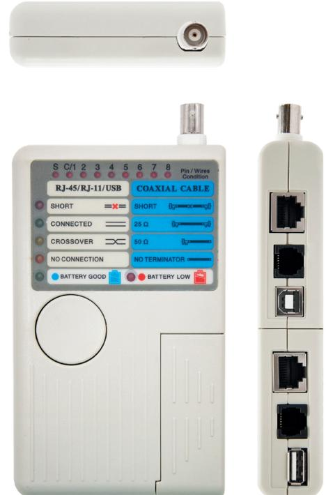
**Tester automático para cables con conectores 8P8C (RJ45), 6P6C (RJ12), 6P2C (RJ11), 4P4C (RJ10) y BNC.**
