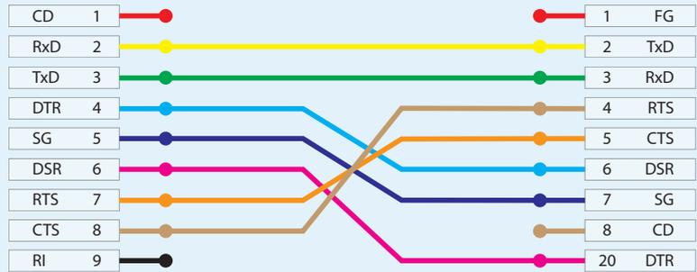
**Características específicas del cable serie NULL MODEM con conector DB9 hembra a conector DB25 macho**
