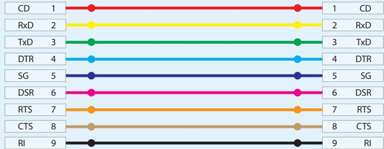
**Características específicas del cable serie RS232 con conector DB9 macho en ambos extremos**
